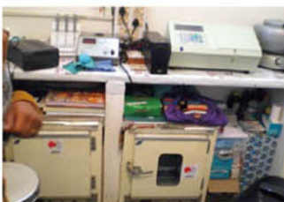
左下はオートクレーブという微生物を加熱殺菌処理する機器。衛生管理に欠かせない。右下はインキュベータ（培養機）。テーブルの上には遠心分離機、成分分析機などが並んでいる。
